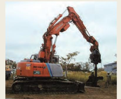
傾斜地などでの施工に適したリーダレス施工機など、さまざまな条件に対応する施工機械を用意
