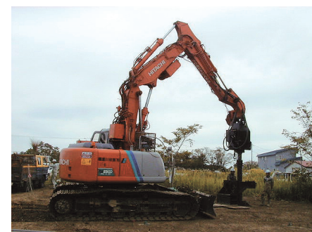
傾斜地などでの施工に適したリーダーレス施工機など、さまざまな条件に対応する施工機械を用意
